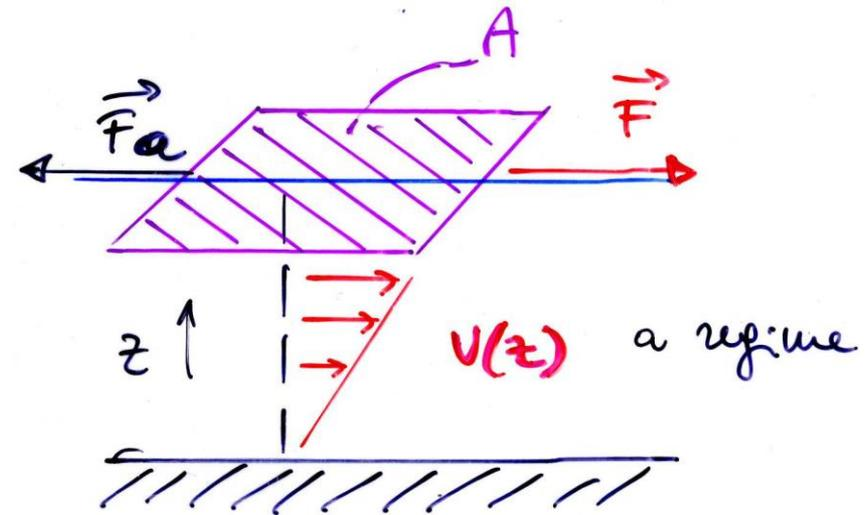
(\*) questo esperimento si può realizzare in pratica mettendo il fluido fra due cilindri coassiali, uno fermo ed uno ruotante
