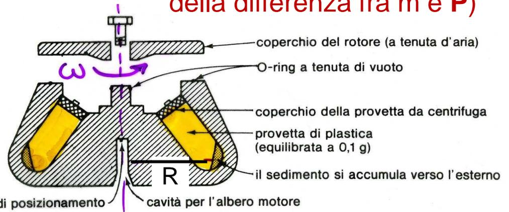
Volume utile provetta limitato  $\propto (1/\omega)^2$
