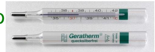
[+] il termometro a Hg è stato messo al bando dalla CE, sostituito da una lega eutettica ternaria di Ga-In-Sn, *Galinstan*<sup>®</sup> (termometro a lettura analogica)
