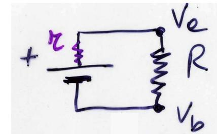
dove  $r$  è la resistenza interna del generatore (piccola), in serie col carico: la corrente erogata è  $<$  di quella erogabile con  $r = 0$  e la ddp utile  $<$  della fem
