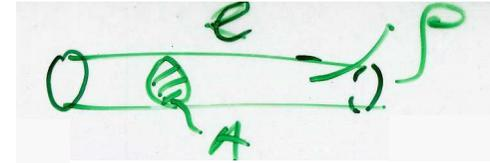
**2a legge di Ohm**, dove  $\rho = \rho(T)$  in  $\Omega \cdot m$  è la resistività e  $\sigma = \sigma(T)$  in  $S(iemens) \cdot m^{-1}$  è la conducibilità elettrica
