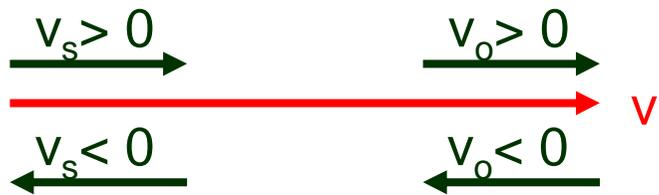
dove  $v_s$ ,  $v_o$  vanno presi con valore e segno: saranno +vi se sono paralleli a  $v$ , -vi se antiparalleli
