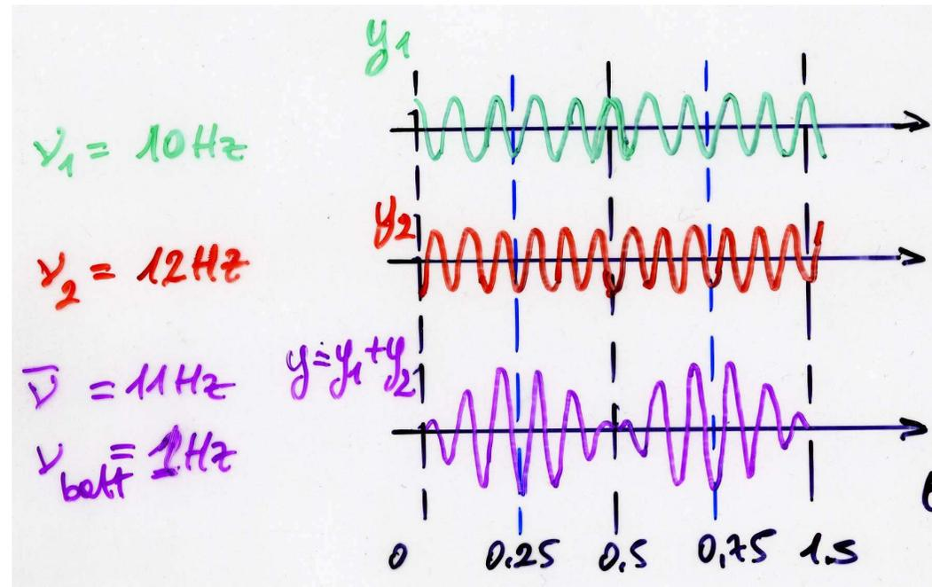
interferenza  $\rightarrow$  frequenza media  $\bar{\nu} = (\nu_1 + \nu_2)/2$  per un termine modulante  $\nu_{\text{batt}} = (\nu_2 - \nu_1)/2$
