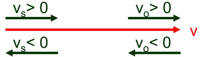
dove  $v_s$ ,  $v_o$  vanno presi con valore e segno: saranno +vi se sono paralleli a  $v$ , -vi se antiparalleli
