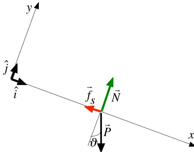
Sul corpo di massa  $m$ , posto su un piano inclinato di un angolo  $\vartheta$  rispetto all'orizzontale, agiscono la forza peso  $\vec{P}$ , la reazione vincolare  $\vec{N}$  e la forza di attrito statico  $\vec{f}_s$ . Per un dato angolo  $\vartheta$  vogliamo determinare il valore minimo del coefficiente di attrito statico  $\mu_s$  necessario affinché il corpo rimanga fermo sul piano inclinato.
