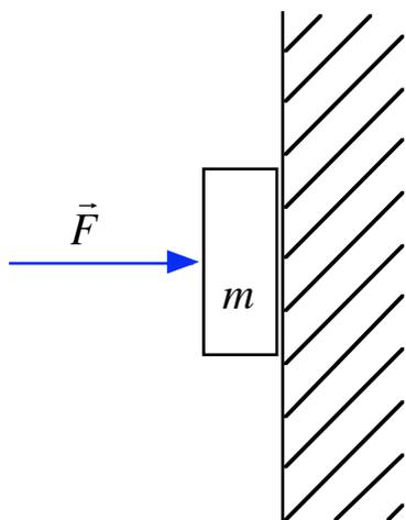
Consideriamo un blocco di massa  $m$  premuto contro una superficie verticale. Il coefficiente di attrito statico tra i due corpi sia  $\mu_s$ . Ci proponiamo di determinare la minima forza  $\vec{F}$  necessaria a tenere il blocco fermo rispetto alla superficie verticale.
