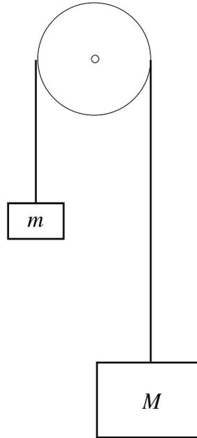
E' costituita da due masse attaccate l'una all'altra da una fune ideale (inestendibile e di massa trascurabile) e sospese tramite una carrucola anch'essa ideale (attrito e massa trascurabili).
