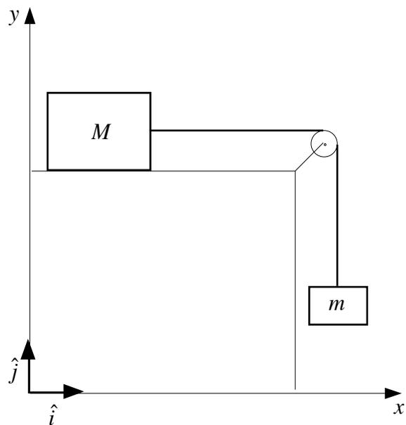
L'apparato in figura è costituito da due masse, connesse tramite una fune ideale che si avvolge attorno ad una carrucola, di cui una è vincolata a muoversi su un piano orizzontale senza attrito.
