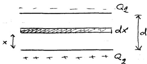
Suddividendo il condensatore in infiniti condensatori, posti in serie, di area  $S$  e spessore  $dx$  considerando lo straterello di dielettrico a distanza  $x$  dall'ar-
