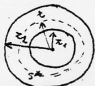
Applico alla superficie  $S^*$  il teorema di Gauss per il campo elettrico e diciamo  $\vec{E}$  la sua direzione normale alle armature
