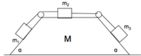
Supponendo che non vi sia attrito tra i tre corpi ed il blocco, si calcoli il valore di  $m_3$  affinché i tre corpi siano in equilibrio: a) nel caso il blocco  $M$  sia saldato alla superficie orizzontale di appoggio; b) nel caso in cui il blocco  $M$  si muova verso destra a velocità costante  $v$  sulla superficie di appoggio. Se il blocco  $M$  inizia a muoversi verso destra con accelerazione  $A = g/2$ , si determini c) l'accelerazione delle tre masse, supponendo  $m_3 = 1$  kg.
