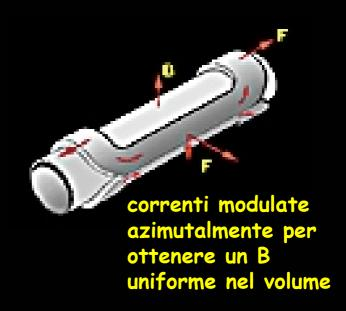
dell'ordine di 100 cavi da 7000 A : cavi superconduttori (seguirà accenno alla superconduzione!)
