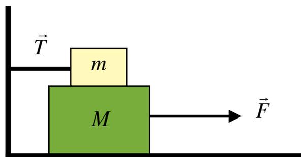
Sapendo che il coefficiente di attrito dinamico fra tutte le superfici è  $\mu = 1/5$  e che il corpo di massa  $M$  si muove con velocità costante, si determini il modulo di  $\vec{F}$  e quello della tensione del cavo  $\vec{T}$ .
