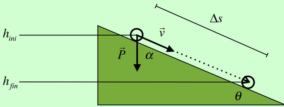
Calcoliamo il lavoro della forza peso agente su di un punto che si muove su un piano inclinato di un angolo  $\theta$  rispetto a terra (con o
