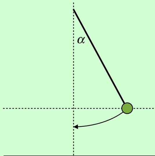
Si determini la velocità massima di rotazione di un pendolo di lunghezza  $l$  sapendo che il punto viene lasciato fermo da una posizione che forma un angolo  $\alpha$  con la verticale.
