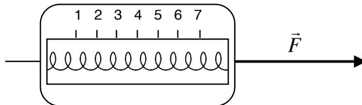
con una molla fissata ad un'estremità. Se applichiamo una forza all'estremità libera del dinamometro esso si deforma. Quando la forza elastica che deriva dalla deformazione bilancia esattamente la forza deformante la risultante delle due forze è nulla ed il sistema meccanico può rimanere fermo indefinitamente (per la prima legge della dinamica). Siamo in condizioni di equilibrio (statico)!
