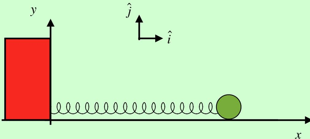
Le forze agenti sul corpo sono: la forza elastica  $\vec{F}_k$ , la forza peso  $\vec{P}$  e la reazione vincolare del piano  $\vec{R}$ . In particolare  $\vec{F}_k = -k\Delta l \hat{i}$ , con  $\Delta l = x - x_0$ ,  $\vec{P} = -mg \hat{j}$ ,  $\vec{R} = R \hat{j}$ . Il corpo può muoversi solo nella direzione  $x$  quindi la sua accelerazione ha la forma  $\vec{a} = \ddot{x} \hat{i}$  e la seconda legge della dinamica si scrive come:
